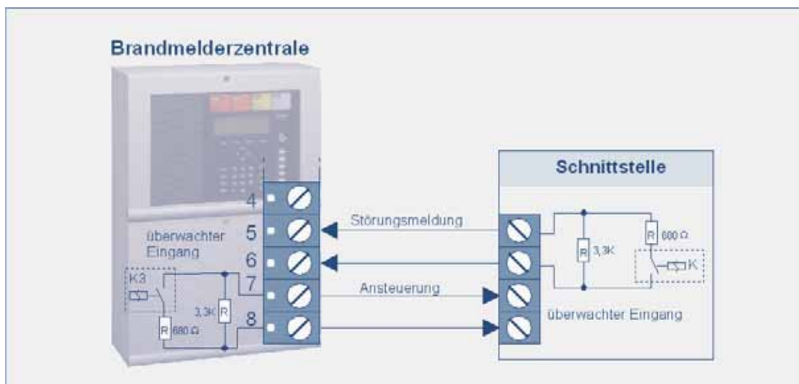
Abb.: Anschaltung – Störung der Sprachalarmanlage (Beispiel)
