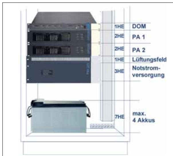
Abb.: Beispiel - Rackmontage
